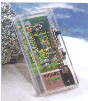
◀ Luxmetervorsatz für Multimeter Zur genauen Erfassung der Umgebungshelligkeit Seite 79
