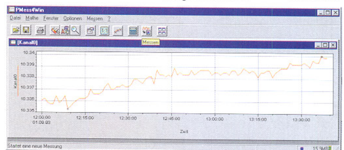
▼ PMess4Win Meß- und Analyseprogramm, das in Zusammenarbeit mit dem ELV RS232-Meßinterface nahezu alle vorkommenden Meß- und Analyseaufgaben löst. Seite 38
