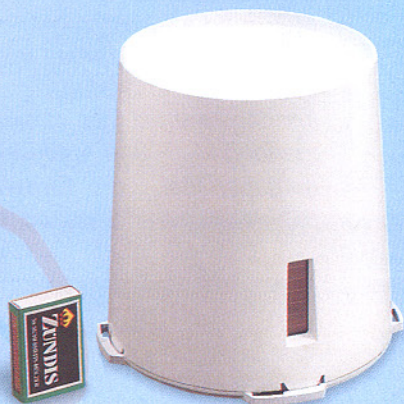
Funk-Regenmengen-Meßsystem S 2000 R mit Solarbetrieb
